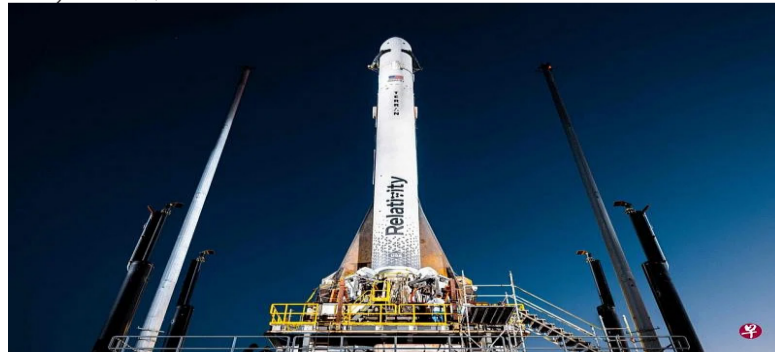
世界上第一枚以3D打印技术制造的火箭Terran 1定3月11日从佛罗里达州卡纳维拉尔角第16号发射台升空。(法新社)
