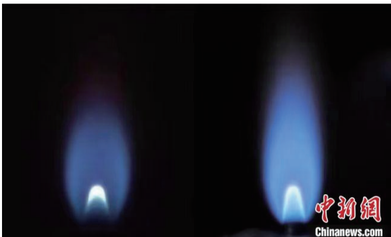
空间站上甲烷燃烧图像(左)与地面同工况甲烷燃烧图像(右)。中科院工程热物理所、清华大学燃烧能源中心供图
