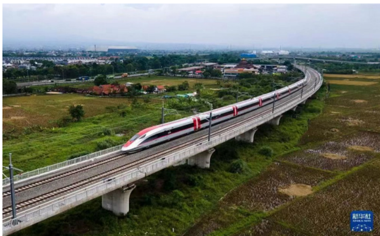
11月9日，在印度尼西亚西爪哇省万隆市，一列高铁动车组正在雅万高铁试验段进行热滑试验（无人机照片）。新华社发（焦宏涛摄）
