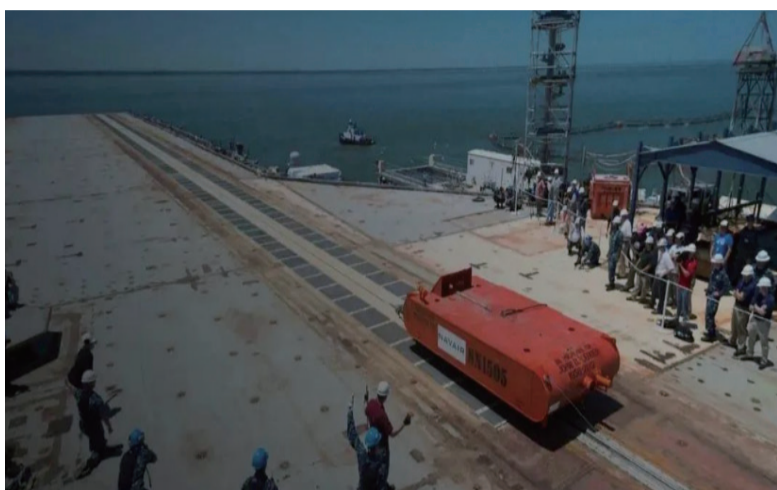
▲福特号航母的电磁弹射装置测试现场
