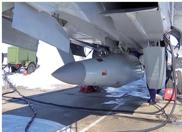
米格-31截击机机腹下可挂载一枚“匕首”导弹。
