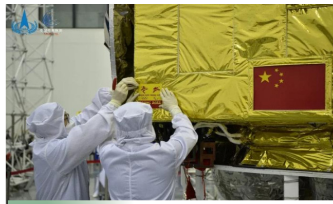
工作人员正在火星环绕器上安装会徽。图片来源：中国探月工程微信公众号
