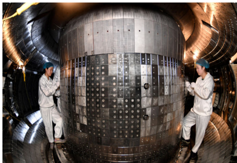
安徽合肥，科研人员在全超导托卡马克核聚变实验装置(EAST)真空室安装高场侧瓦片(资料图)
