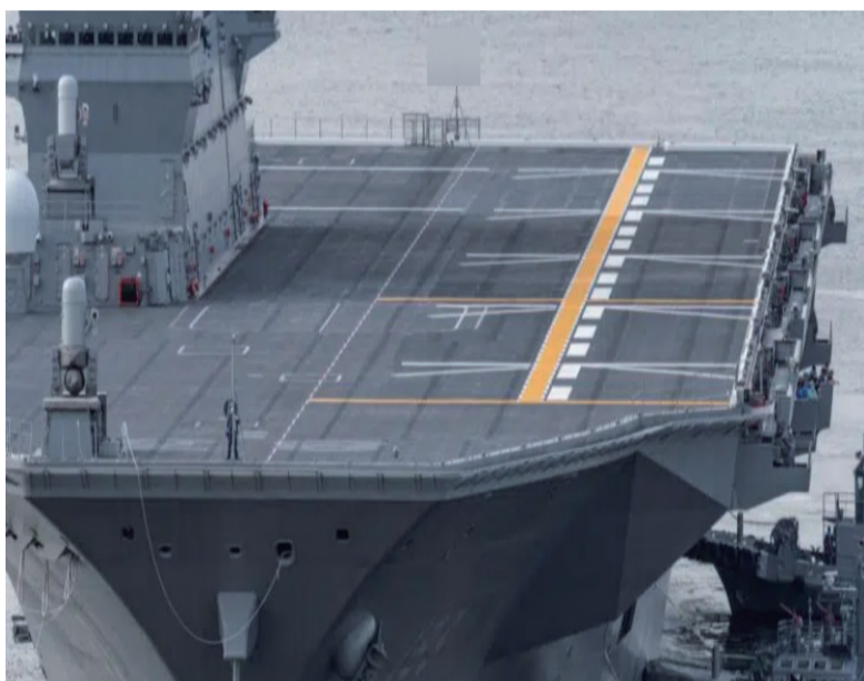
完成改装的“出云”号，涂上了从舰 至艏贯穿飞行甲板的黄色标识线。
