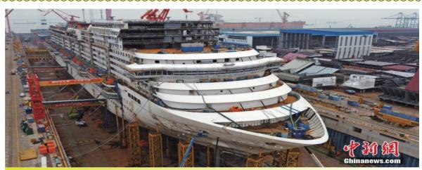
9月2日,航拍正在建造中的中国首制大型邮轮船身。当日,记 者从中国船舶集团旗下上海外高桥造船有限公司了解到,首制 大型邮轮H1508船艏部驾驶室总段完成搭载吊装工作,船艏9 个关键总段搭载吊装工作全部结束。这将为未来一个月全船主 船体贯通奠定坚实的基础,标志着主船体贯通工作全面进入收 尾阶段。(无人机照片) 中新社记者 殷立勤 摄
