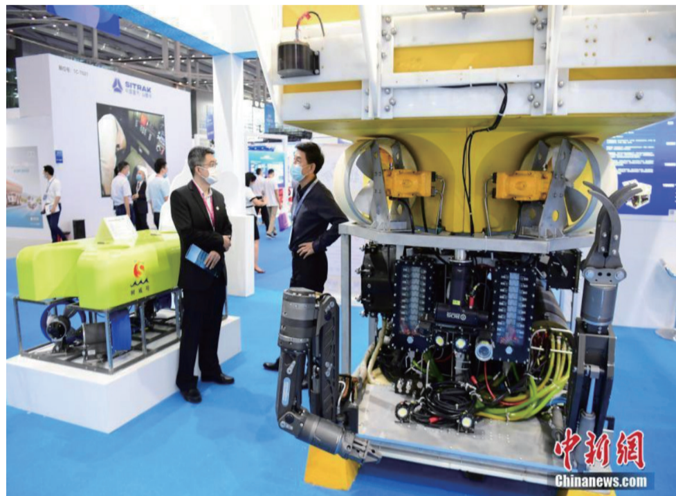
图为深圳市德威胜潜水工程公司研制的可深潜1500米的立德号水下作业机器人。
