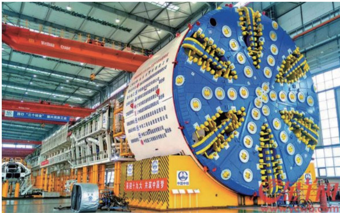
汕头海湾隧道西线隧道掘进使用的中国国产“巨无霸”盾构机
